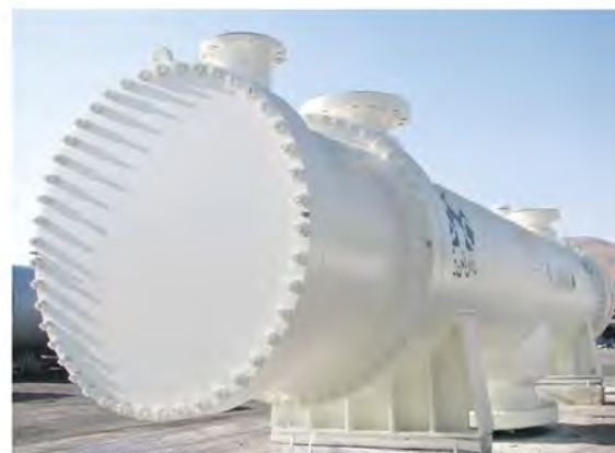
مبدل حرارتی تیتانیوم فاز ۱۴ پارس جنوبی South Pars phase 14, titanium heat exchanger
