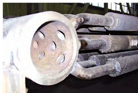
مونتاژ هارپ های نیروگاه های سیکل ترکیبی
