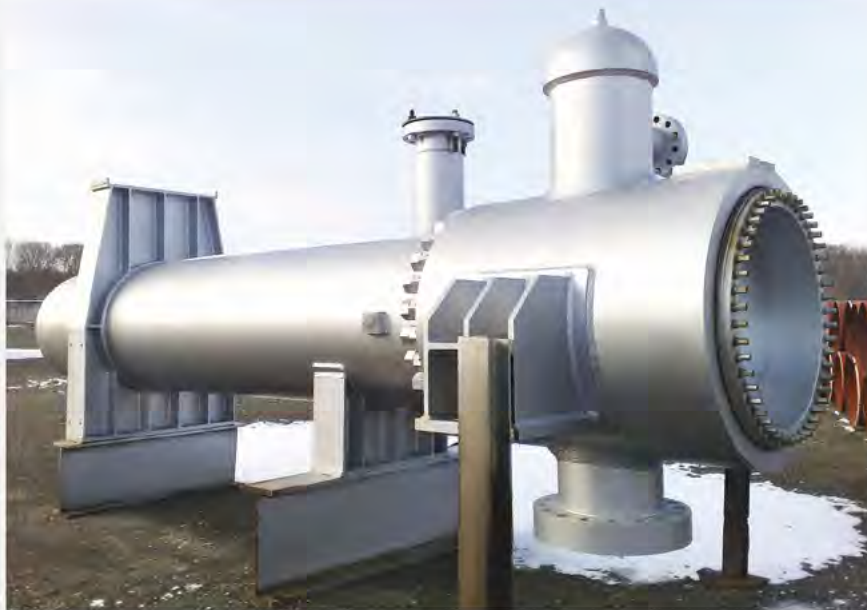
مبدل حرارتی Breech-Lock واحد ایزوماکس پالایشگاه امام خمینی سازند Imam Khomeini refining isomax unit Breech-lock heat exchanger
