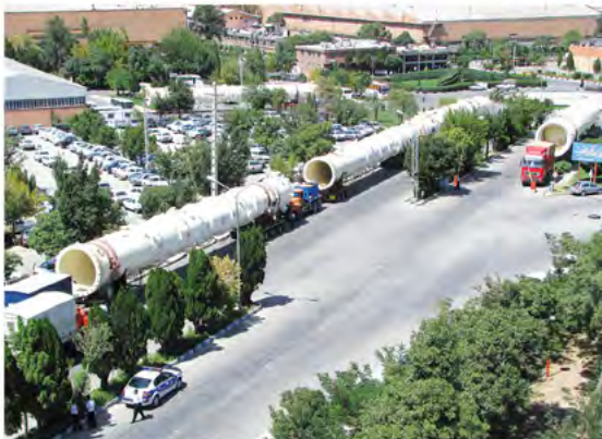
مخزن فاز ۱۴ پارس جنوبی South Pars phase 14, pressure vessel
