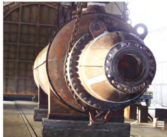
عملیات تنش زدایی مبدل حرارتی پارس جنوبی South Pars heat exchanger stress releasing
