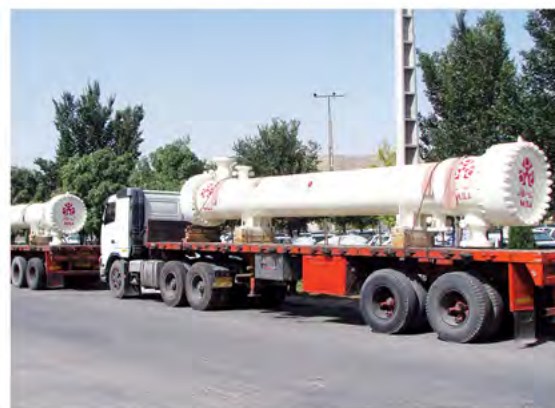
مبدل های حرارتی فاز ۱۴ پارس جنوبی South Pars phase 14, heat exchangers
