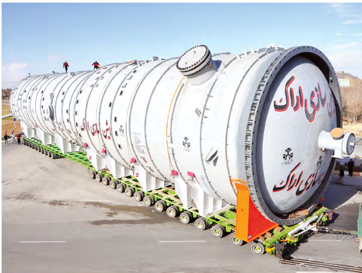
برج اصلی پالایشگاه امام خمینی شازند Shazand Imam Khomeini oil refining main column
