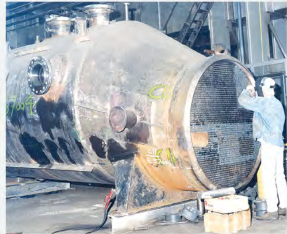
عملیات جوشکاری تیوب به تیوب شیت Tube to tube sheet welding
